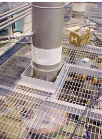
安装在机体上的裙式排气 过滤布袋，用于过滤并排 出含尘的气体 Integrated skirt filter hose for ventilation of dusty air
