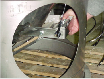
翻板式排料阀并配置了位置信号 发射器 Flap discharge valve with position signal transmitter
