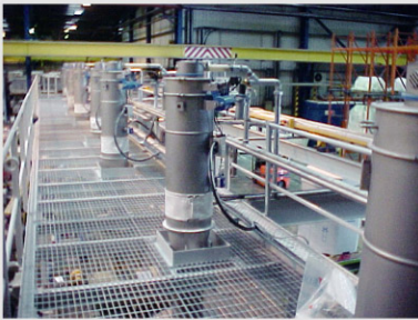
使用一个负压风机带动多个吸 料机 multiple universal hopper loaders with one vacuum pump
